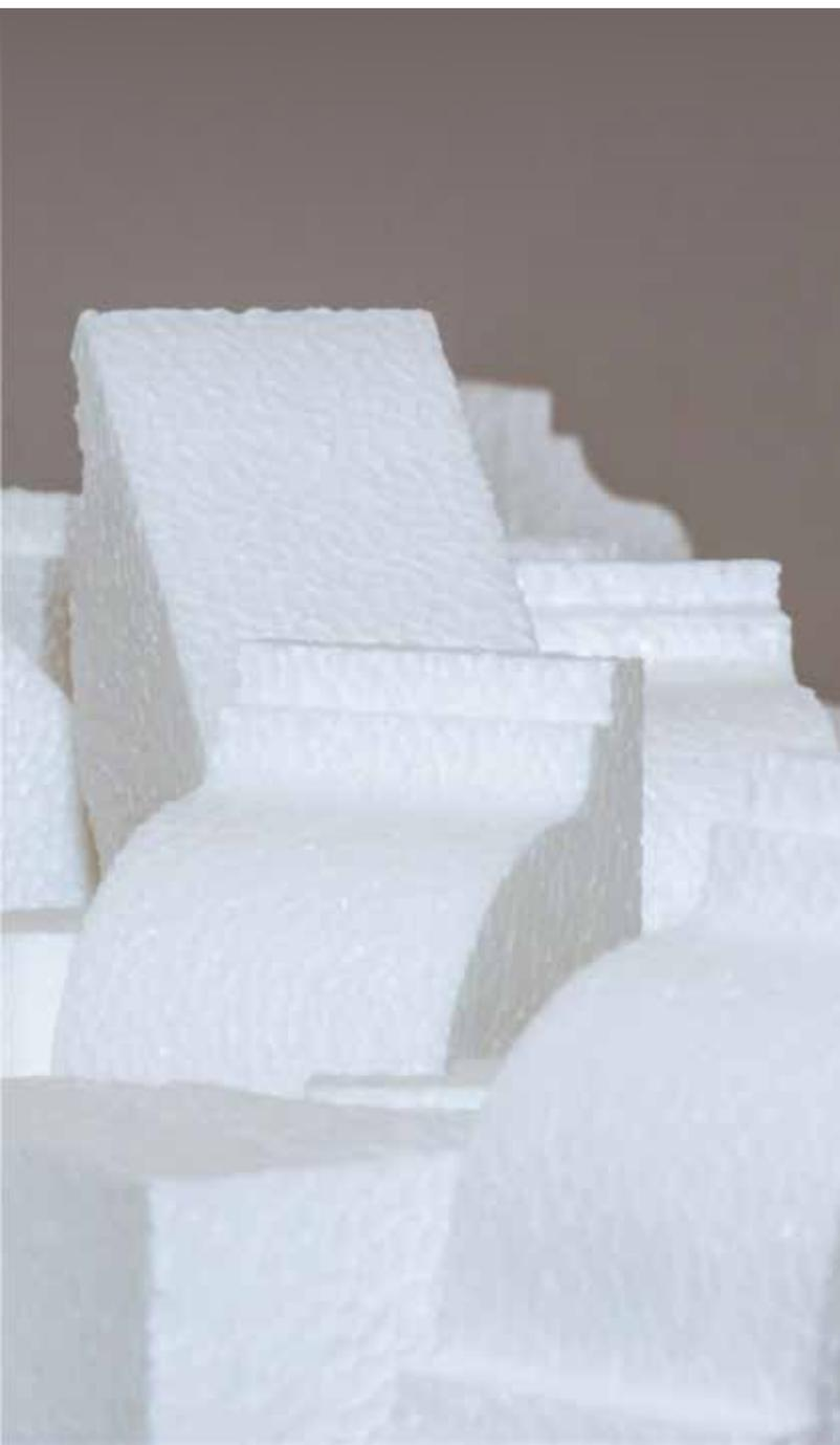
Il Polistirene Espanso Sinterizzato (EPS) è un materiale perfettamente adattabile alle particolarità di ogni progetto edile, si presta ad ogni tipo di taglio, usando un particolare pantografo sul quale viene impostato il disegno richiesto dal progettista o dal committente.
